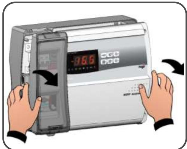
**Fig. 6 :** En faisant fléchir les charnières, faites basculer la façade de 180° vers le bas pour accéder à l'intérieur du contrôleur ; déconnectez le connecteur de la carte électronique.
