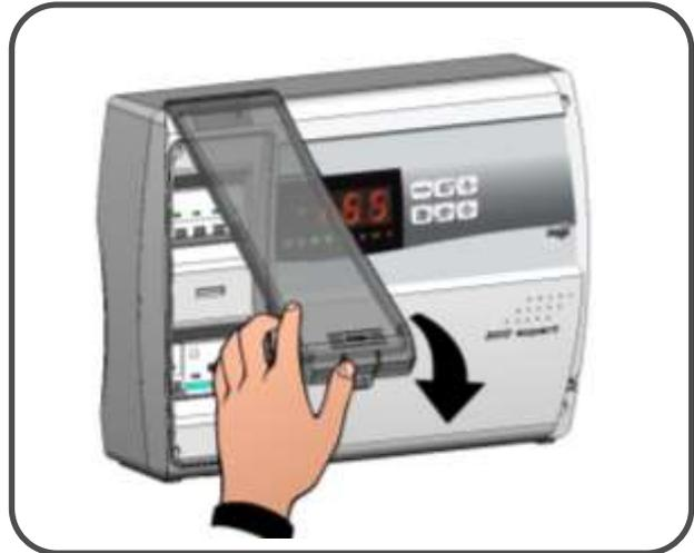
**Fig. 5 :** Ouvrez la façade du boîtier en soulevant celle-ci et en faisant glisser les deux charnières jusqu'en fin de course.
