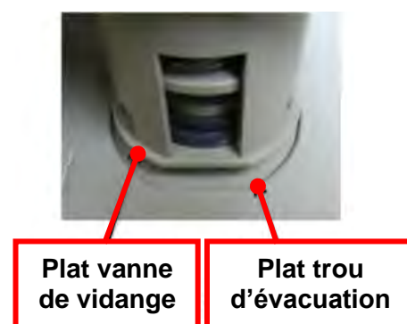
Figure 19 : Sens électrovanne de vidange
