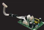
Platine interface pour le raccordement de la télé- commande filaire tactile G-UTY-TWRXZ2-2
