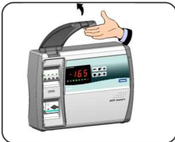
**Fig. 2 :** Retirez l'habillage des vis sur le côté droit.
