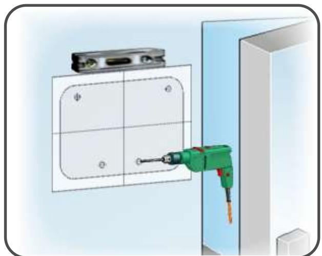
**Fig.10 :** Utilisez les trous réalisés précédemment pour fixer le fond du boîtier à la paroi : prenez quatre vis ayant une longueur adaptée à l'épaisseur de la paroi où vous souhaitez fixer le contrôleur. Appliquez une rondelle en caoutchouc (fournie) entre chaque vis et le fond du boîtier.
