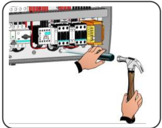
**Fig. 9 :** Utilisez le gabarit de perçage pour effectuer quatre trous de fixation sur la paroi.
