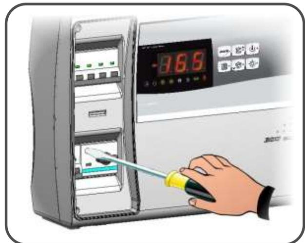
**Fig. 17 :** Étalonnez en agissant sur la vis de réglage située en façade du disjoncteur.
