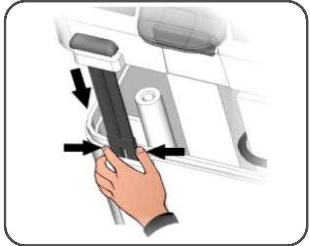
**Fig. 13 :** En faisant fléchir les charnières, faites basculer la façade de 180° vers le bas pour accéder à l'intérieur du contrôleur ; reconnectez le connecteur de la carte électronique.
