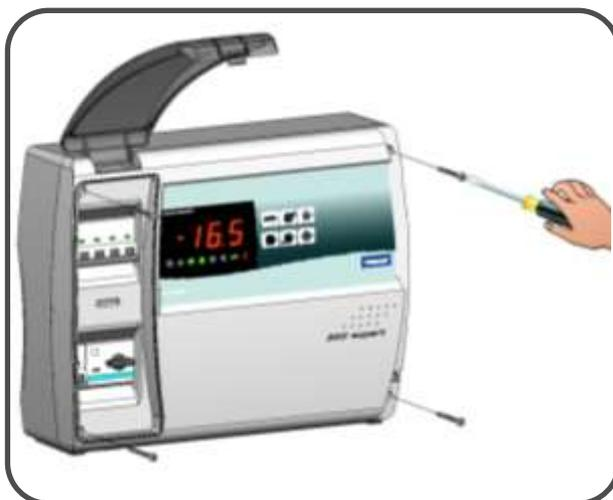
**Fig. 4 :** Fermez le couvercle transparent protégeant le disjoncteur magnétothermique général.
