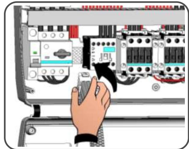
**Fig. 14 :** En cas de connexion du contrôleur au réseau TeleNET / Modbus-RTU ou en cas d'utilisation du relais Aux / Alarme, effectuez les connexions nécessaires directement sur les bornes de la carte électronique. Pour le parcours des câbles, il est conseillé de disposer côte à côte les câbles et le cordon de connexion existant entre la carte électronique et le fond du boîtier.
