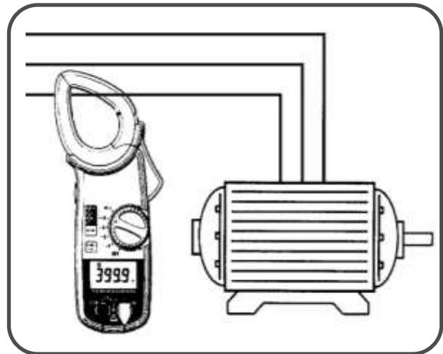
**Fig. 16 :** Étalonnez le disjoncteur en fonction de l'absorption constatée. Dans tous les cas, la valeur paramétrée ne doit pas dépasser la valeur maximale prévue par le constructeur du compresseur.
