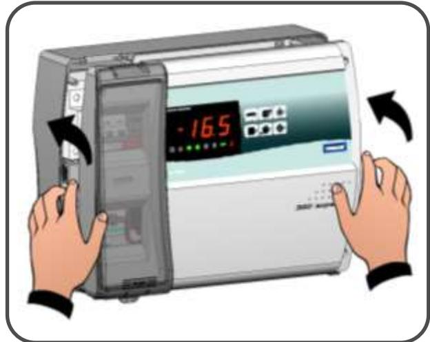
**Fig. 19 :** Fixez le couvercle frontal à l'aide des 4 vis prévues à cet effet. Remettez l'habillage des vis sur le côté droit.
