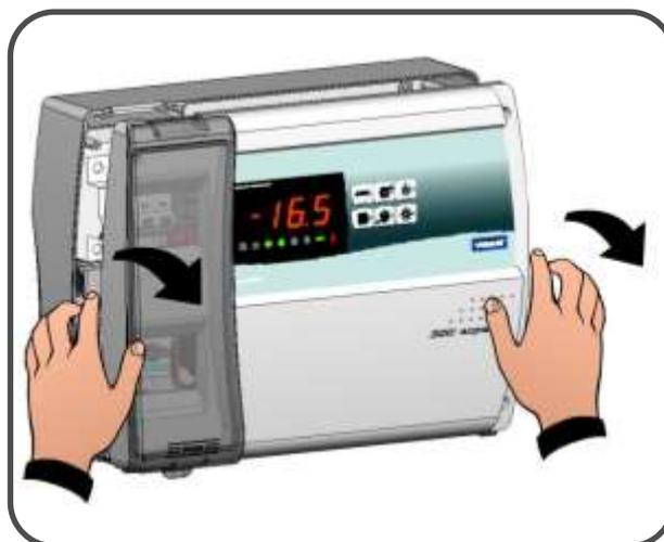
**Fig. 6 :** En faisant fléchir les charnières, faites basculer la façade de 180° vers le bas pour accéder à l'intérieur du contrôleur ; déconnectez le connecteur de la carte électronique.
